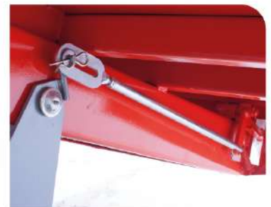
Destravamento da tampa traseira por tirante de fácil regulagem
