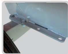
Diversas posições de montagem do eixo, regulando o peso sobre o trator.
